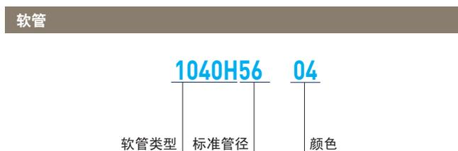
标准管径代码：等于软管外径。
